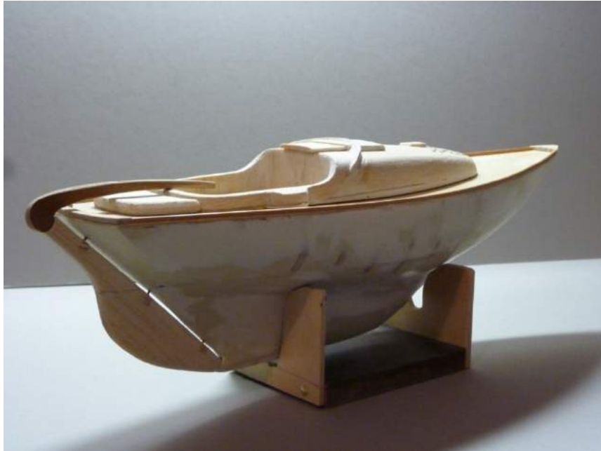
Heckansicht mit Ruderblatt und Pinne aus Teakholz.
