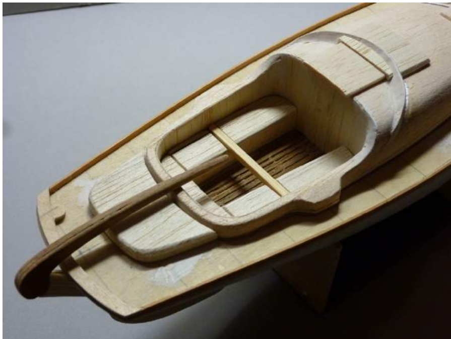
Blick in die Plicht. Lattengrätting wurde aus Teakholzfunier hergestellt.
